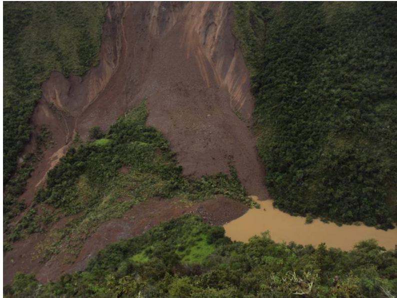
Figura 8: Material de escombros antes del desembalse y puntos de surgencia, producto de filtraciones en la masa del derrumbe. Tomada del registro fotográfico de la Municipalidad de Limatambo.
