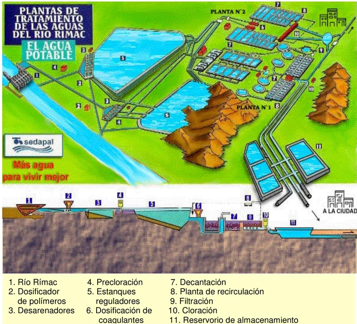
Figura 349. Esquema de la planta de tratamiento de la Atarjea
