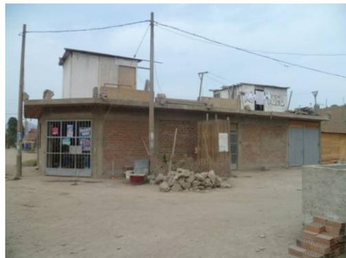
Figura 125. Vista de una vivienda mixta (vivienda - comercio) de albañilería confinada con diafragma rígido
