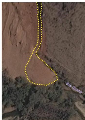
Figura 10. Flujo de detritos, margen izquierda del río Quera
