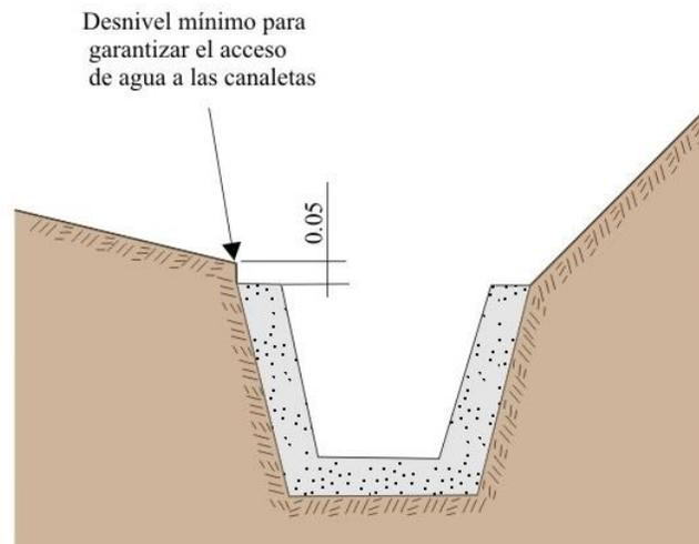
Figura 20. Detalle de una canaleta de drenaje superficial.
