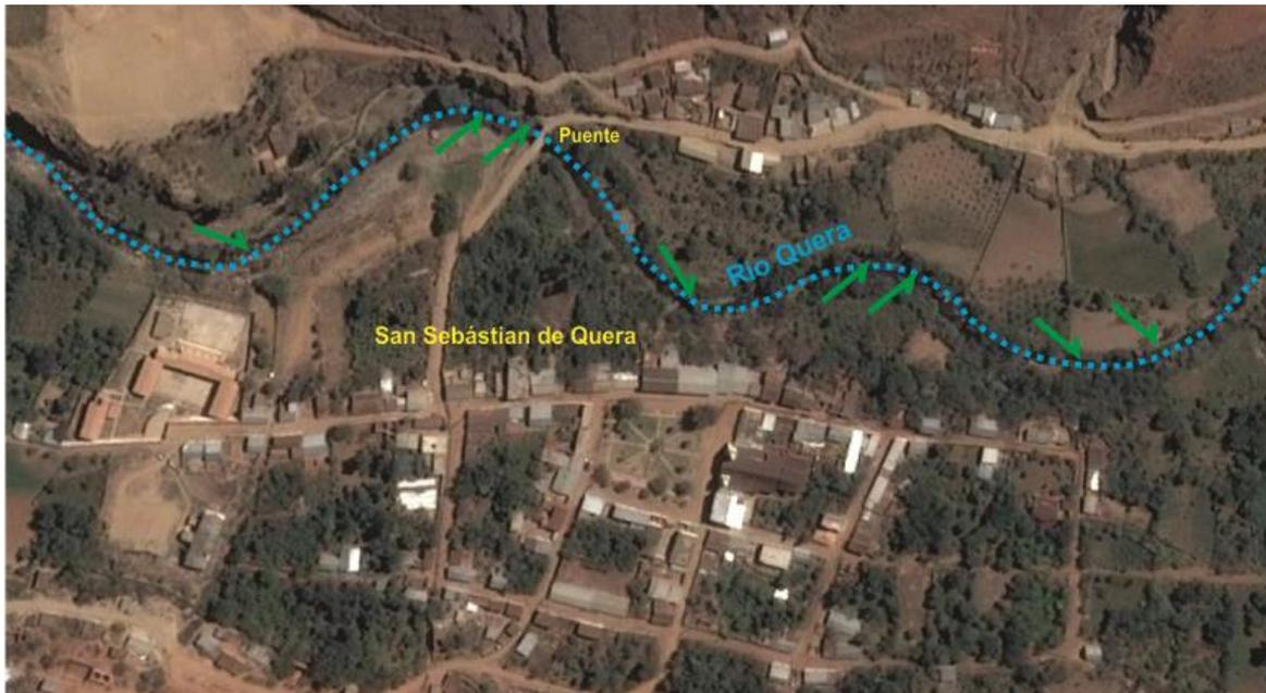
Figura 11. Se muestra al río Quera, en forma sinuosa y zonas con procesos de erosión (líneas verdes).
