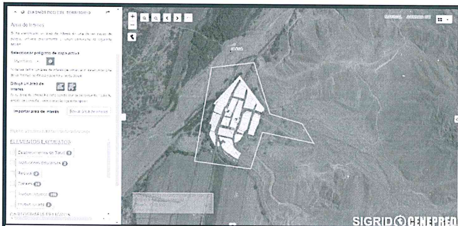
Verificación de Manzanas y Lotes que se encuentran expuestos ante una probable activación de la quebrada La Isla (CONSULTA SIGRID)
