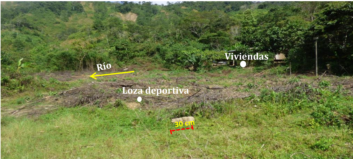
Figura 9: Vista del material transportado por el flujo de lodo (clastos y arbustos), depositado sobre la loza deportiva.
