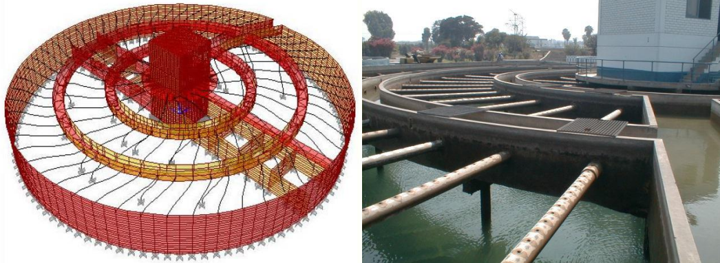
Figura 96. Idealización matemática del decantador
