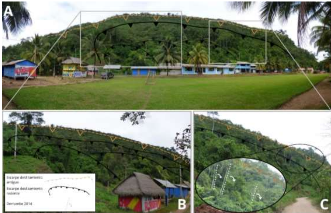
Figura 9. A) Deslizamiento antiguo y reactivaciones de la ladera sur de Pitocuna. B) detalle de reactivaciones progresivas del deslizamiento de Picotuna. C) Árboles inclinados en el cuerpo del deslizamiento de Pitocuna.
