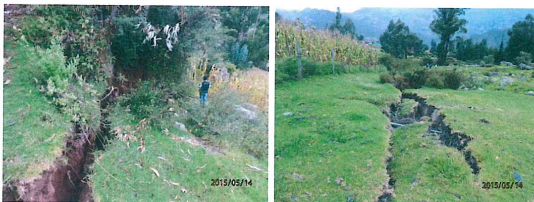
Foto 11: Vista viendo al sureste, donde se observa Corona de la escarpa en el sector Yacupañahuin, con salto vertical de 1.50 m con abertura que varía entre 0.10 m a 0.25 m.
