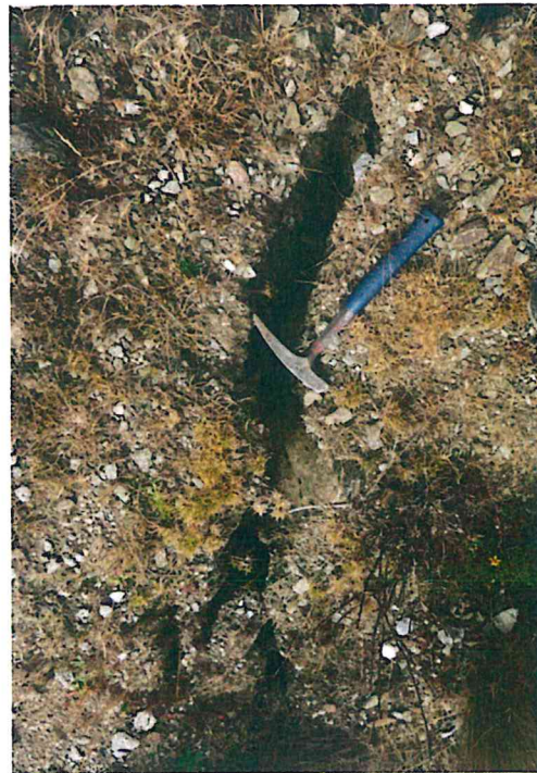
Fotos 13 y 14. En vista de la izquierda se muestra el desplazamiento horizontal y vertical que tiene el terreno, en la derecha, los agrietamientos del terreno
