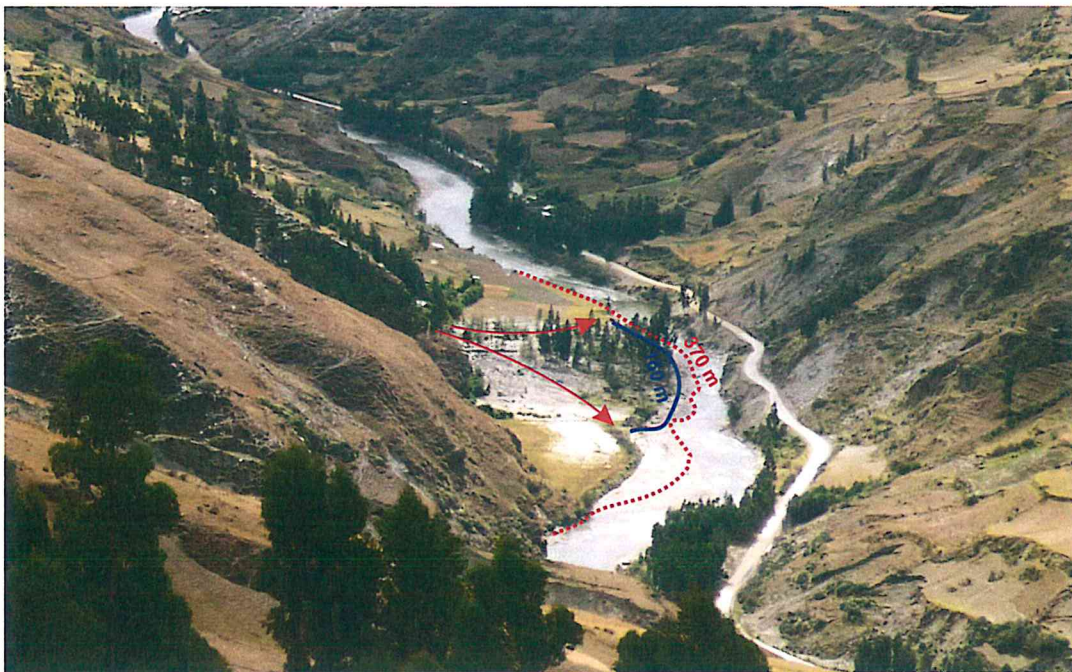
Foto 34. Abanico del flujo de detritos proveniente de la quebrada Tingo Chico, que hizo migrar al cauce del río Marañón de la margen izquierda a la derecha, en un tramo de 160 m (marcado líneas azules), estrechando al cauce del río. Se aprecia también el abanico antiguo marcado con líneas rojas que tiene una longitud de 370 m.
