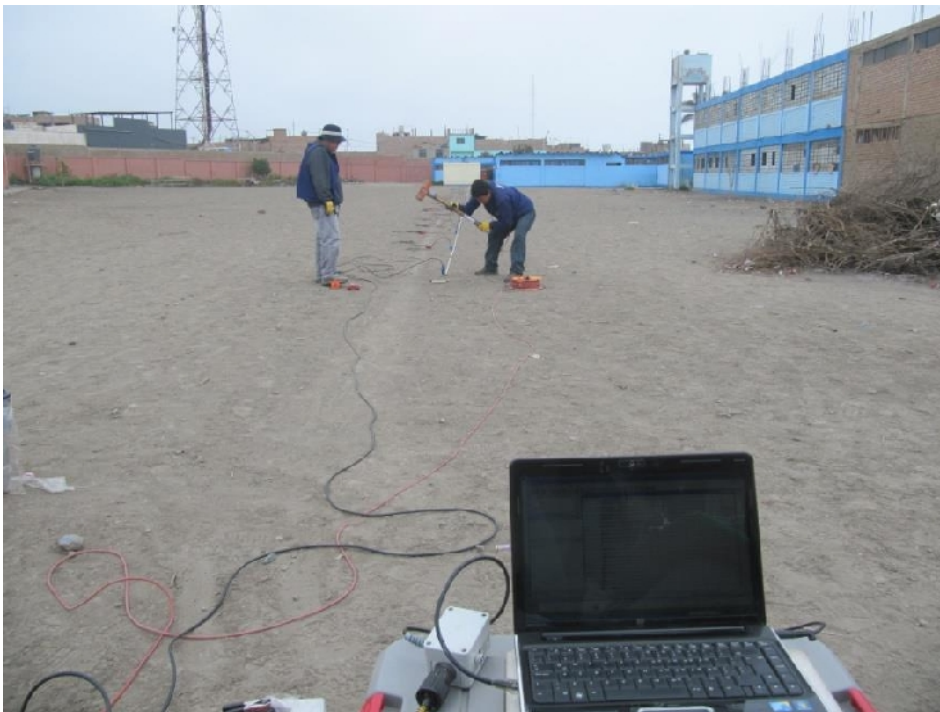
Figura 12: Imagen de la disposición del equipo de refracción sísmica para el registro de datos
