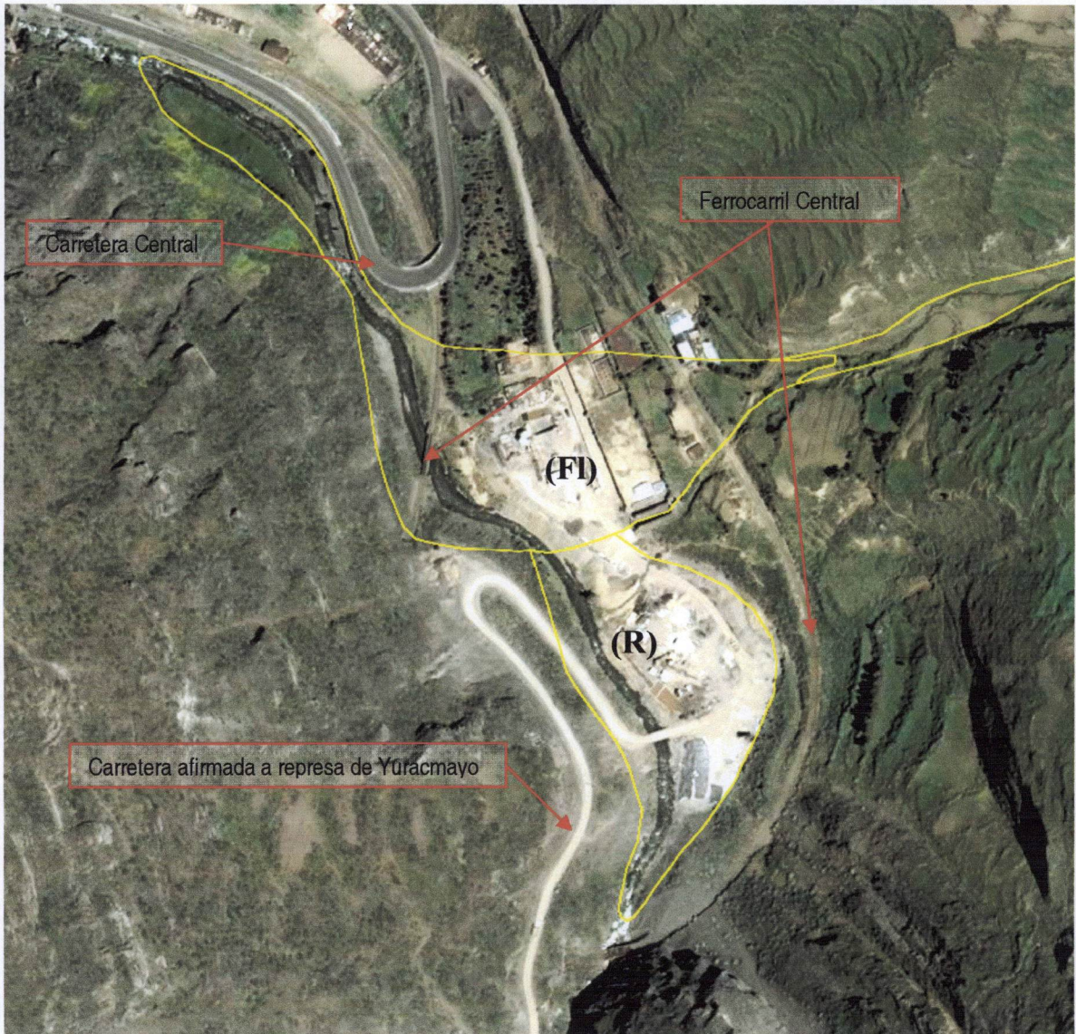
Imagen Satelital N° 2. Zona afectada por el flujo (FI) y el represamiento (R). Fuente de la Imagen: Google Earth.
