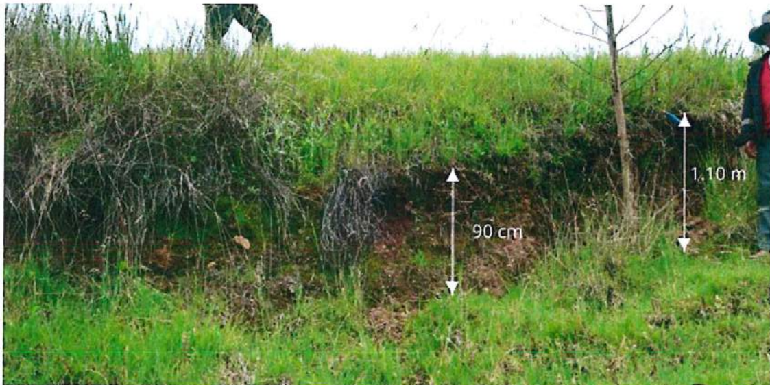
Figura 12. Escarpe secundario con un salto de aproximadamente 0.60 m.
