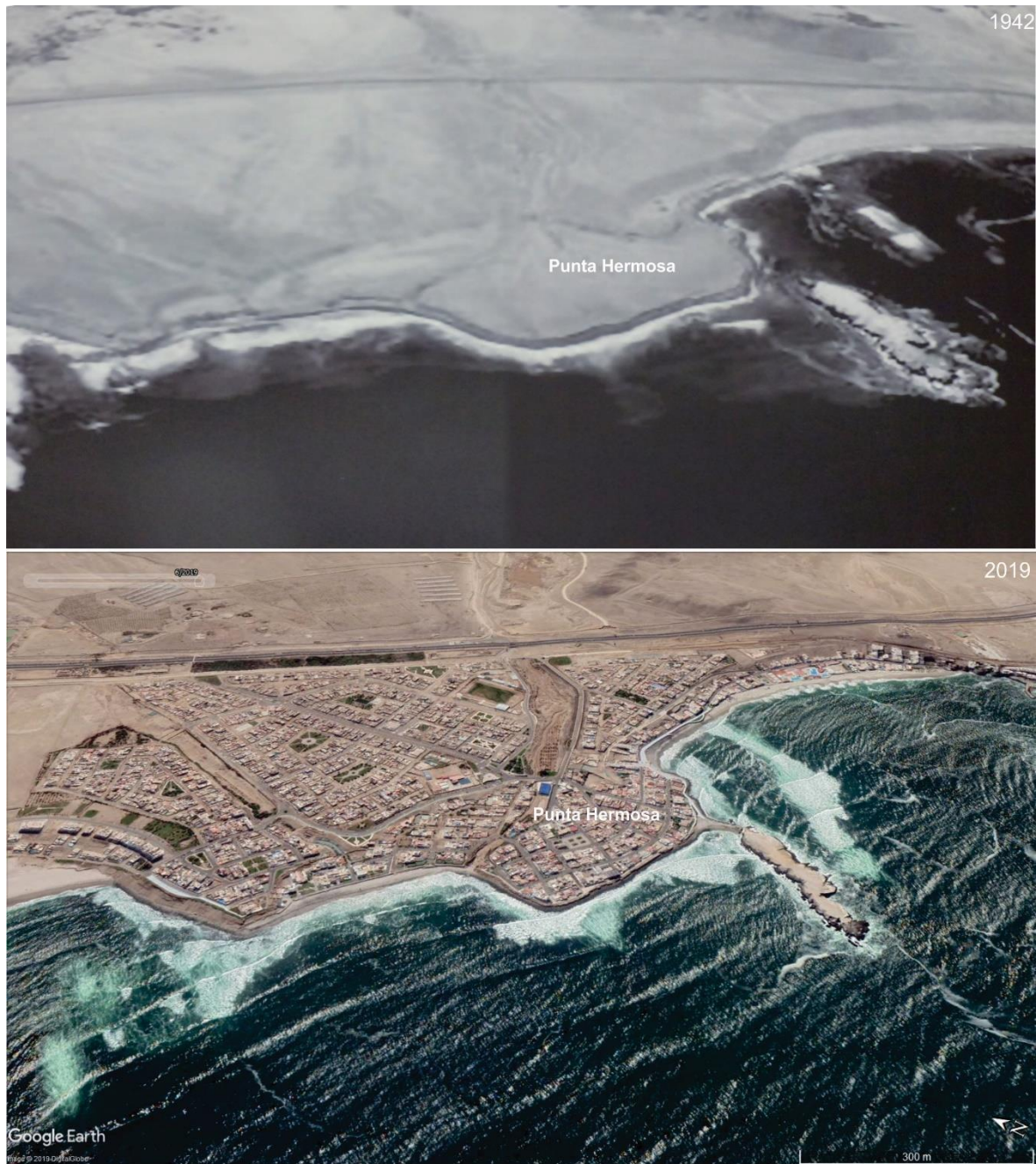
Figura 7. Imágenes comparativas del área de Punta Hermosa en 1942 y 2019. La vista superior muestra el abanico en la quebrada Río Seco dejado por un huaico antiguo, sin ocupación humana (Foto aérea 16-10-1942); en la vista inferior se observa la zona urbana actual de Punta Hermosa asentada sobre el antiguo abanico de la quebrada Río Seco (Vista del Google Earth, 2019)
