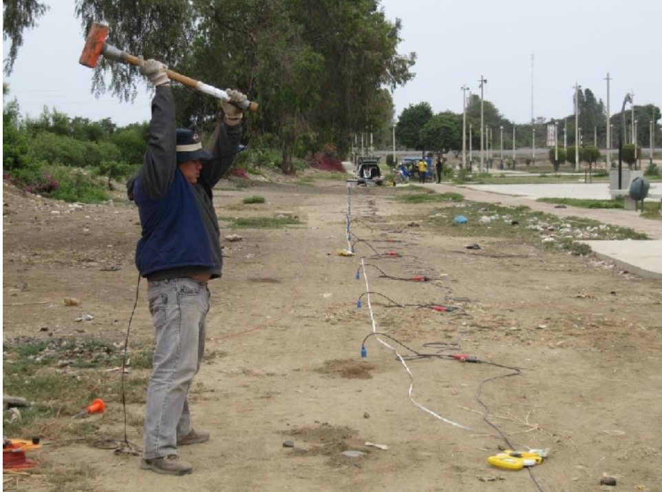
Figura 11: Imagen de la disposición del equipo de refracción sísmica para la toma de data
