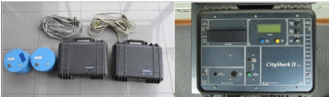
Figura 8: Equipo sísmico utilizado para el registro de vibraciones ambientales: sensores Lennartz (2N) y registrador CityShark
