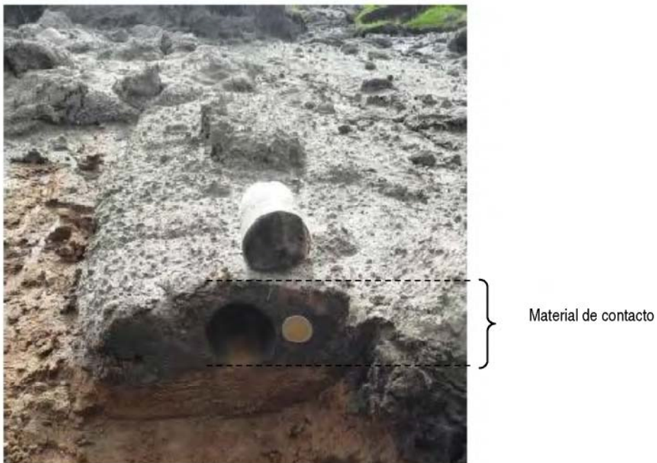
Foto N° 4. Material de contacto areno limoso de color gris blanquecino de consistencia baja.
