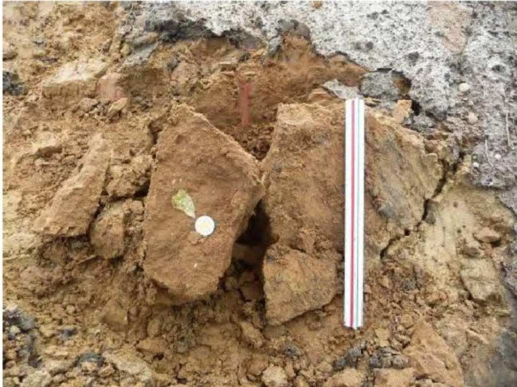
Foto N° 5. Roca muy meteorizada y alterada, compuesta de arenisca tobacea retrabajada, lodolita y fragmentos líticos volcánicos. Matriz de arena limosa de color pardo rojizo de resistencia blanda.
