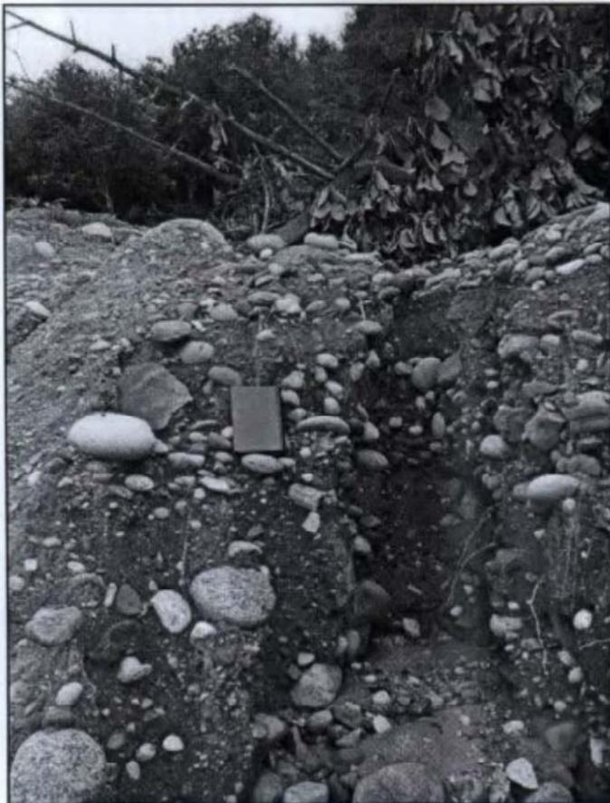
**Foto 12.-** Vista de la disposición del material traído por el flujo (huayco), esta de forma muy caótica.
