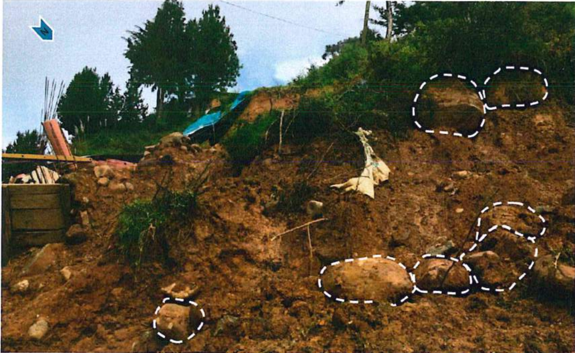
Figura 05. Litoclastos de hasta 1m de diámetro en matriz arcillo arenosa de color rojizo desplazados por los movimientos en masa.
