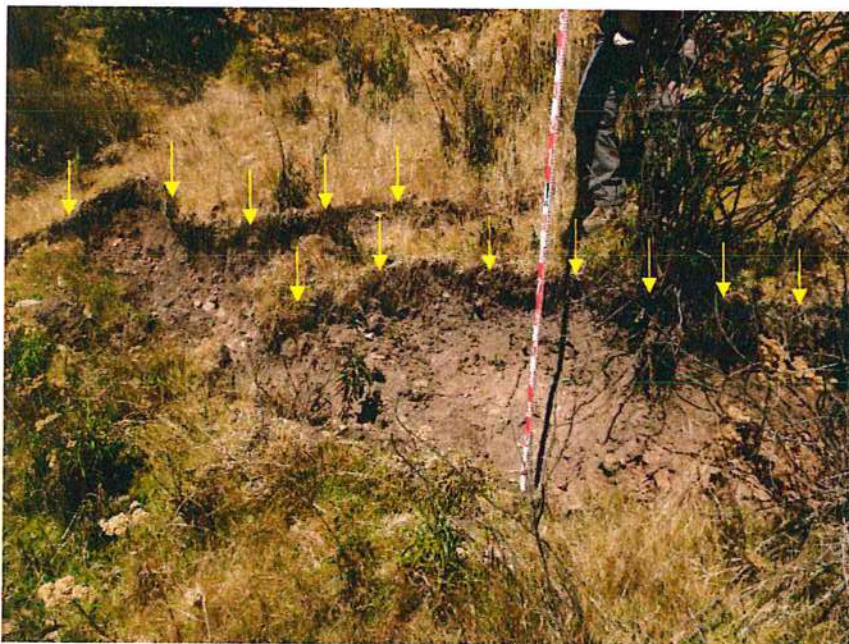
Figura 10. Vista al sur del escarpe de deslizamiento con altura vertical de 75 cm.
