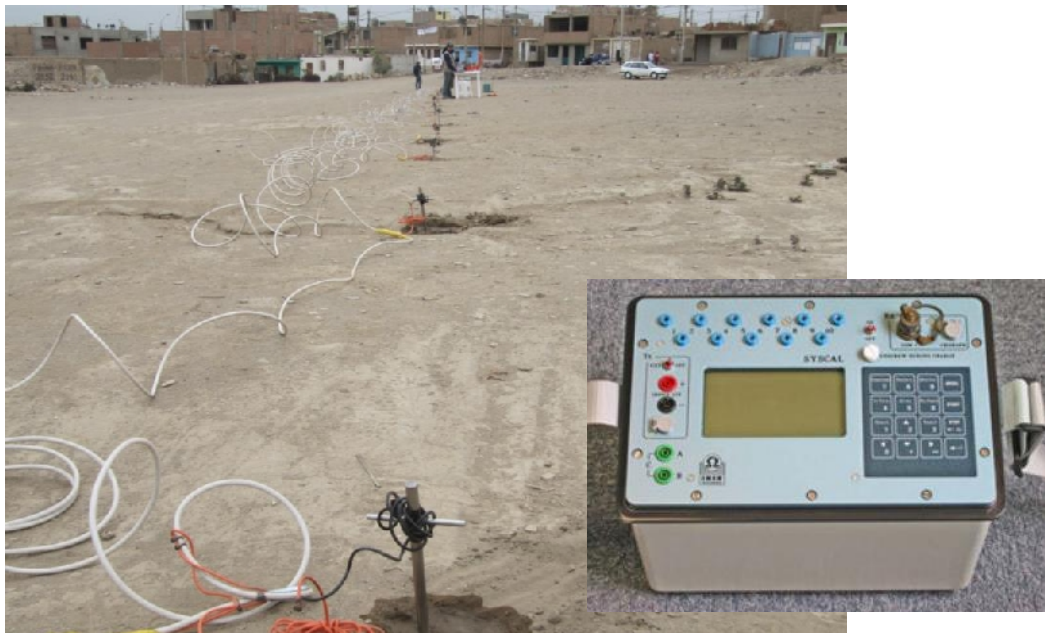
Figura 12: Imagen de disposición del equipo de prospección eléctrica para la toma de datos
