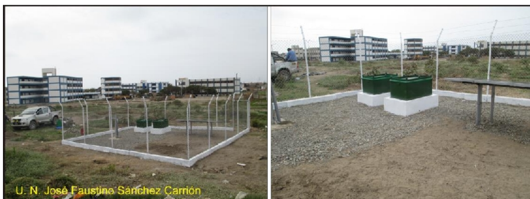
Figura 5: Estación Acelerométrica en el interior de Campes de la U. N. José Faustino Sánchez Carrión.
