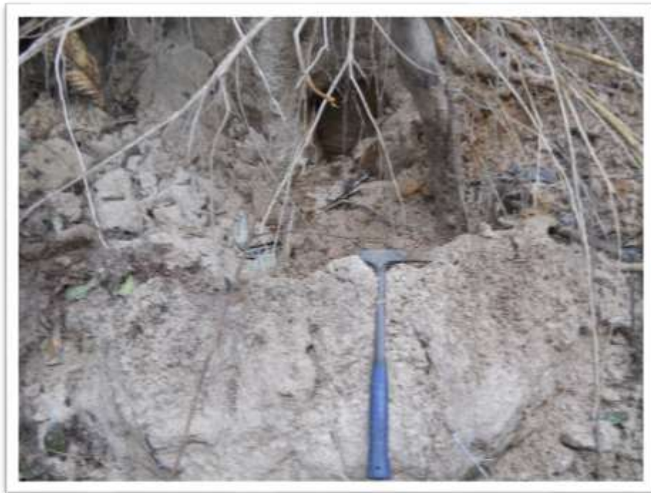
Foto N° 1: Secuencia de areniscas blanquecinas, algo plomizas, con alta meteorización, con bloques subangulosos con diámetros de 15 cm en promedio.
