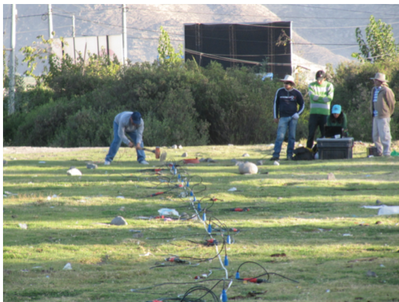
FIGURA 9. Imagen de la disposición del equipo de refracción sísmica para la toma de data en el Distrito de Sachaca
