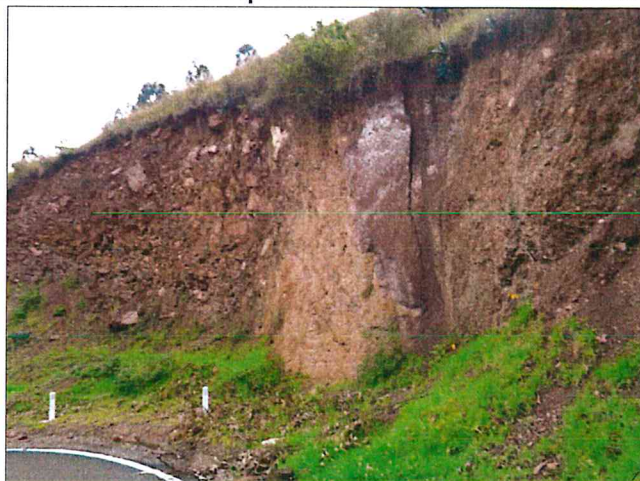
Foto 2: Vista de afloramiento en corte del Volcánico Porculla. Observar el alto grado de fracturamiento de las rocas que favorece los movimientos en masas rocosas
