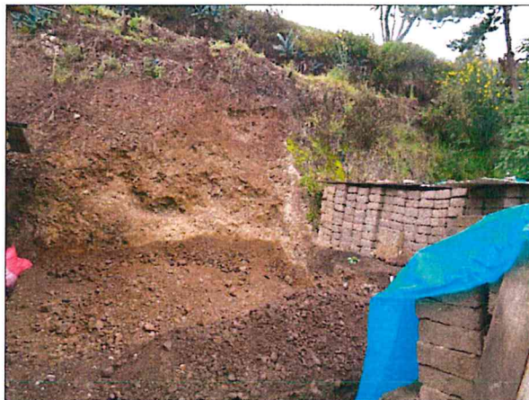
Foto 5: Vista en corte de depósitos coluviales del cuaternario reciente. Se observa la pobre estratificación del material
