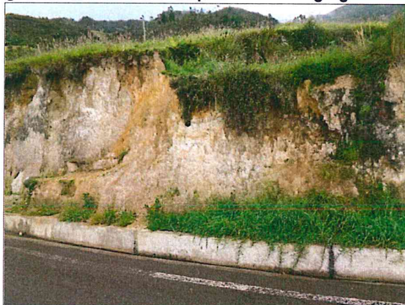
Foto 1: Corte de afloramiento de los Volcánicos Llama en el sector de Salalá. Observar el grado de meteorización química con disgregación rocosa
