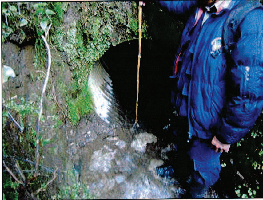
Foto 22. Medición del caudal en el canal de descarga de la Laguna Angascococha (tomado de: Madueño, 2011).
