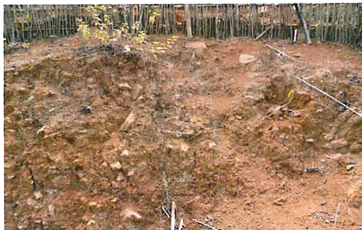
FOTOGRAFÍA N° 10: Depósitos coluviales que se distribuyen en la zona de reconocimiento de campo. Se observan aliterados y poco compactos.
