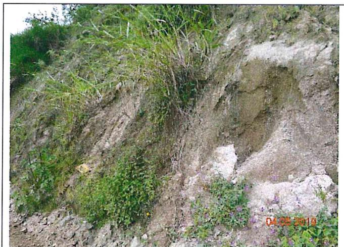
Corte de afloramiento de tonalita-diorita Pambarumbe. Observar la roca meteorizada de aspecto friable y de fácil disgregación granular con generación de abundante material de arenas.
