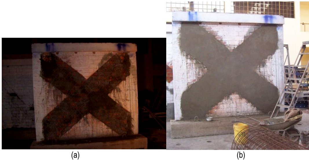
Figura 101: Reforzamiento con bandas de refuerzo.
