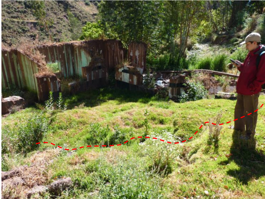
Salto de terreno ubicados en la zona del Centro Artesanal (ahora destruido).
