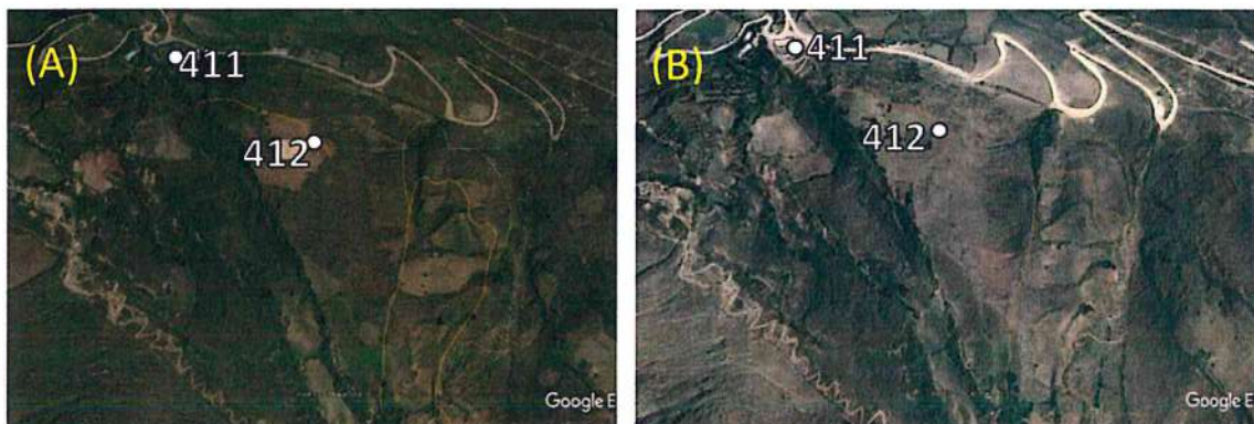
Figura 21: Análisis comparativo de imágenes satelitales de los años 2005 y 2007, y la foto tomada en la presente evaluación: (A): Año 2005 sin presencia de deslizamientos en el punto 411 (punto donde se hizo observaciones) y se ve los materiales antiguos movidos y sus escarpas. (B): Año 2017 al mejorar la carretera arrojan material a la quebrada y generan deslizamientos. (C): Año 2019 se genera un deslizamiento en el punto 412 (punto donde se hizo observaciones) dentro del material antiguo movido, por debajo de la cárcava antigua.
