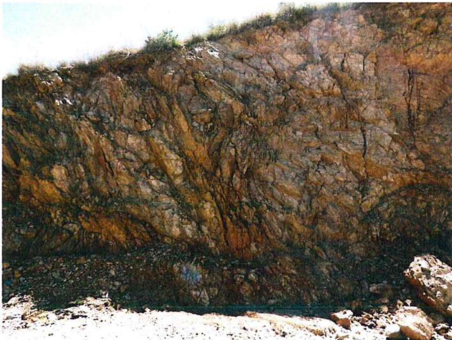
Fotografía 1: Se aprecia los esquistos alterados con coloración amarillenta bastante fracturados y plegados.
