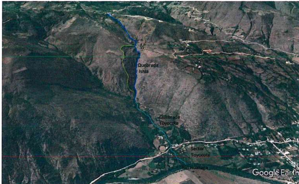
Figura 20: Sector Toyocote, junto al río Hullaga; la línea de color azul es la quebrada Ishla y la celeste la quebrada Toyocote. Las líneas verdes son escarpas antiguas de deslizamientos y las naranjas son los cuerpos de los deslizamientos antiguos.
