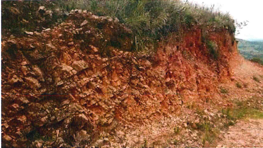
Foto 02: Afloramiento de areniscas con moderada a alta meteorización.
