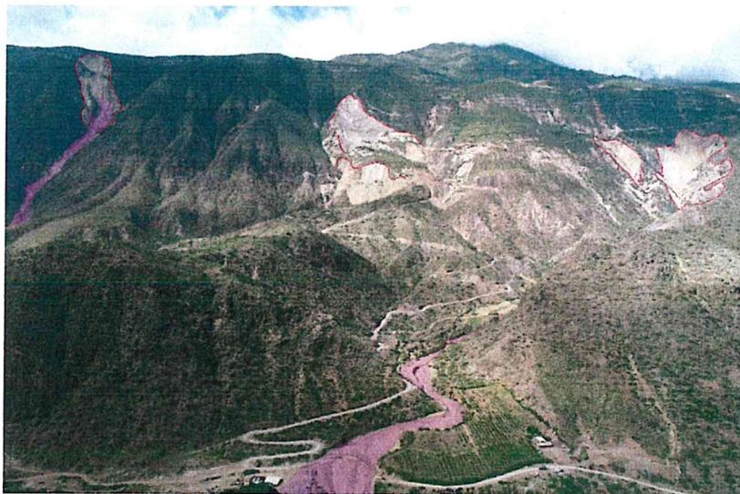
Figura 14. Vista panorámica del cerro La Colpa, se observa derrumbes que aportan material al fondo de la quebrada y en periodo de lluvias intensas estas se desarrollan y forman flujos de detrito (huaicos)
