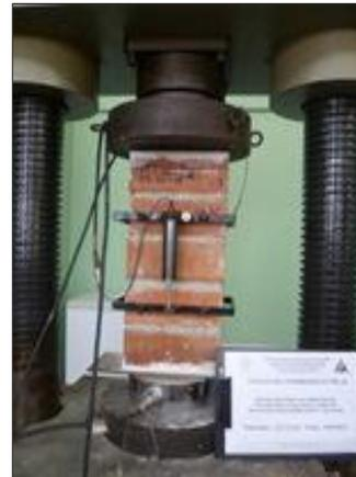
Figura 17: Ensayos de Pilas en ladrillos solidos
