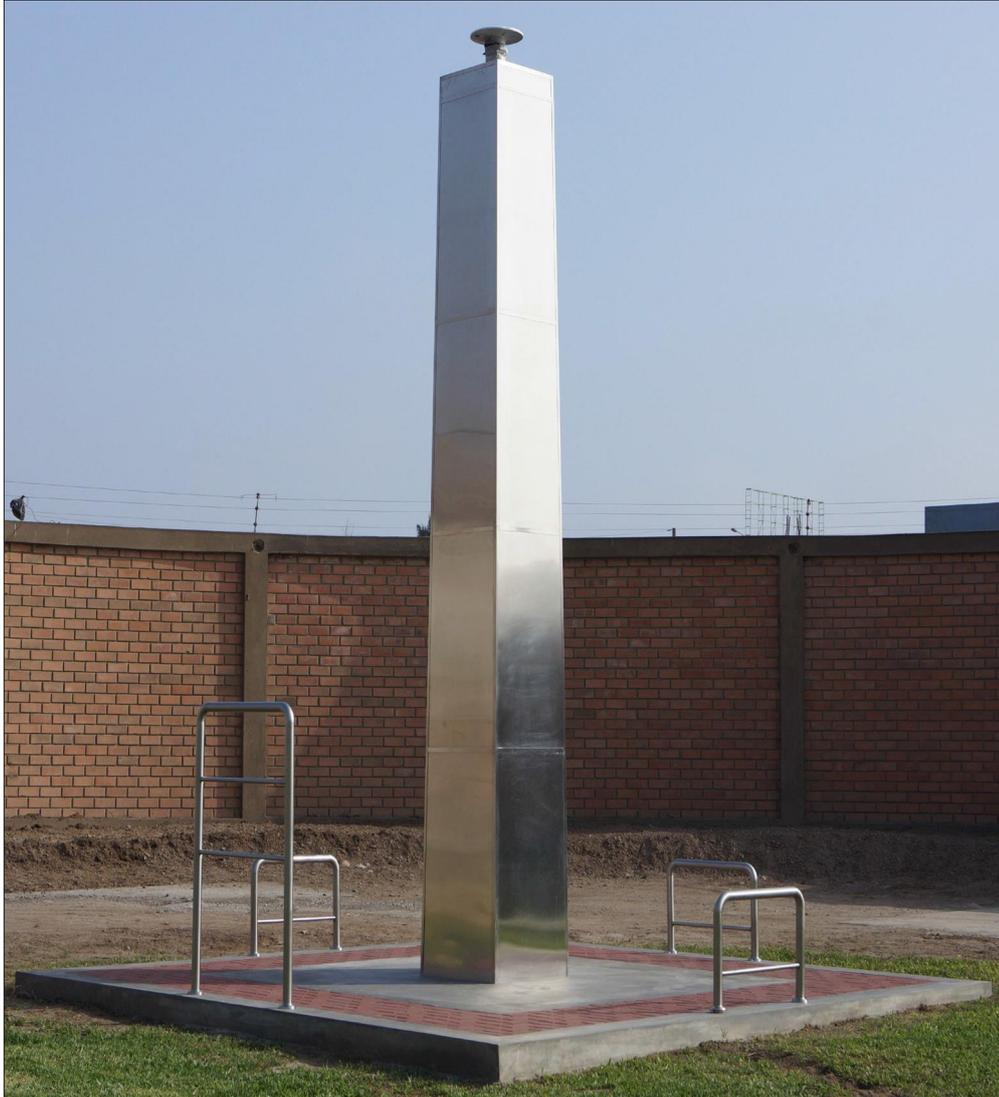
Figura 34: Estación de Referencia GPS de Operación Continua instalada en el Campus CISMID.
