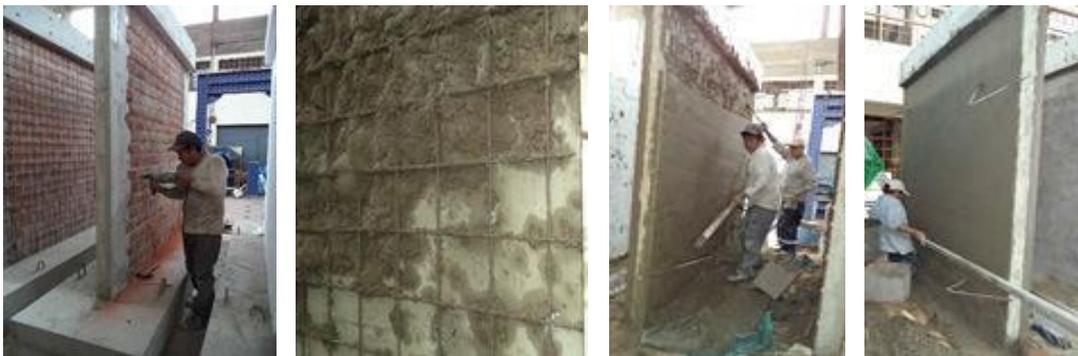
Figura 28: Estudio experimental de nuevas técnicas de reforzamiento en muros de albañilería.
