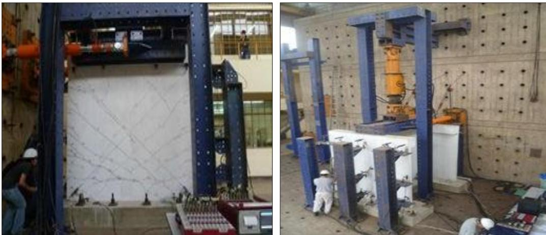
Figura 25: Ensayo cíclicos en muros de ductilidad limitada.
