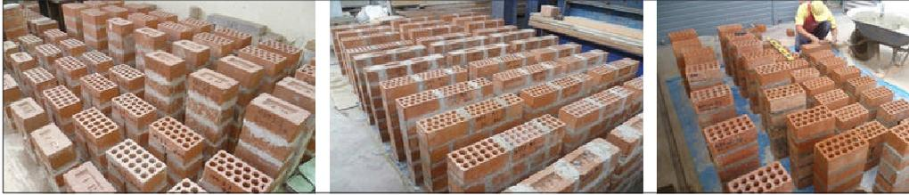
Figura 16: Muestras de Pilas y Muretes de ladrillo sólido, hueco y tubular que fueron ensayadas
