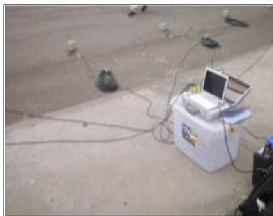
Figura 4(a): Equipo GEODAS 15-HS para medición de microtrepidaciones.
