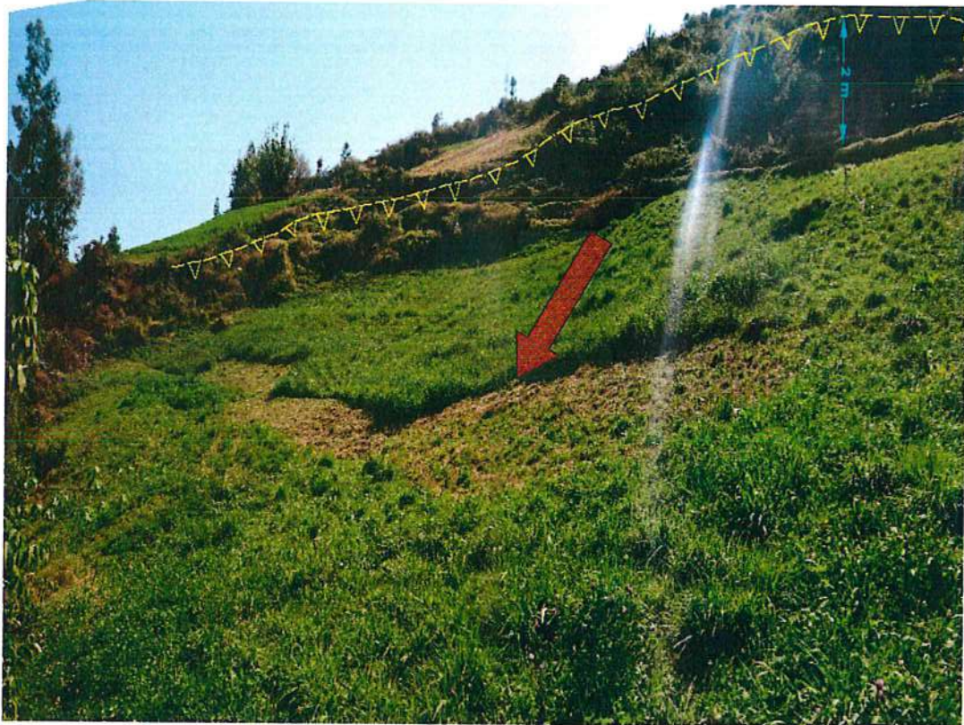
Figura 8. Vista de la primera escarpa de deslizamientos antiguo, cubierta de vegetación; se ha marcado con líneas de color amarillo el trazo de la escarpa de deslizamiento antiguo. El mal sistema de riego (inundación) está saturando considerablemente el manto, aumentando el peso y haciendo perder estabilidad.
