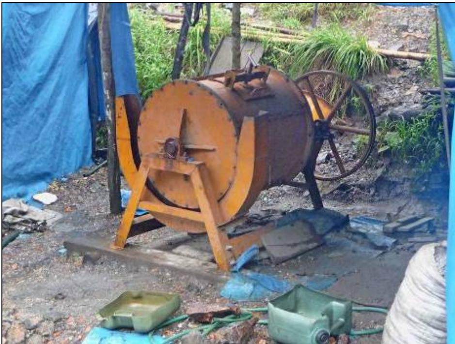
Foto 5.- Molino que es usado para la trituración del material extraído de la mina.
