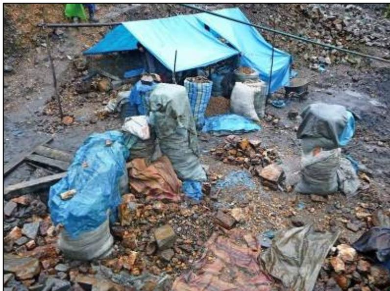
Foto 3.- Disposición del desmonte de mina, en sacos, para su posterior tratamiento de molienda.
