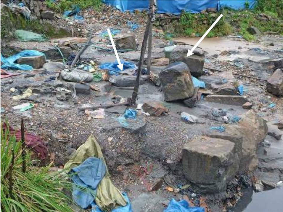
Foto 6.- Método usando quimbaletes, usando dos rocas.
