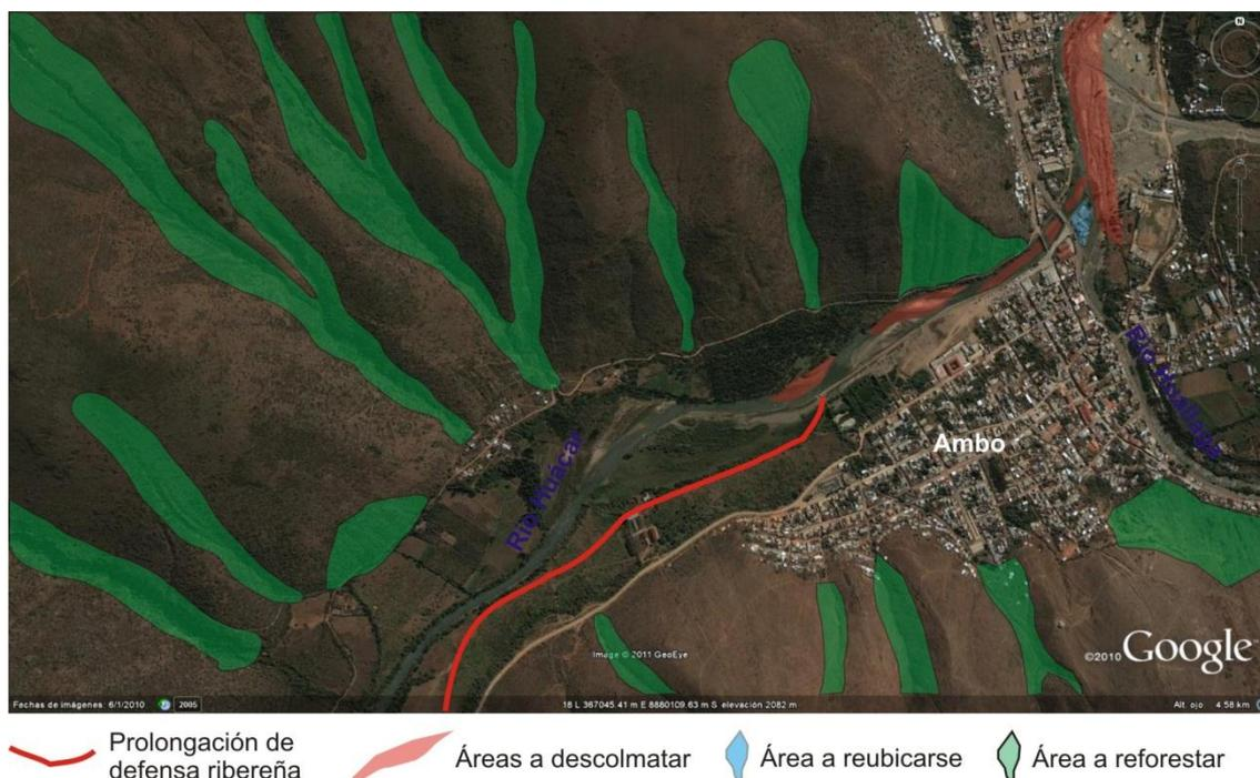
Figura 10: Medidas correctivas para erosiones e inundaciones fluviales y erosiones de ladera.
