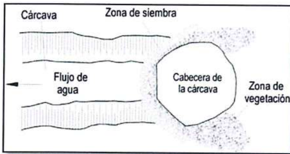
Figura 34. Esquema de disposición de vegetación en cabecera de la cárcava. Gray y Leiser (1989).
