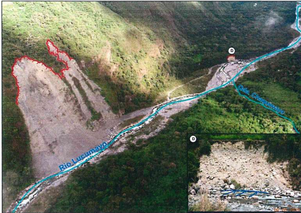
Figura 35. Procesos de remoción en masa en el sector Chaquimayo. Se identificaron derrumbes, producto de la dinámica fluvial del río Lucumayo.
