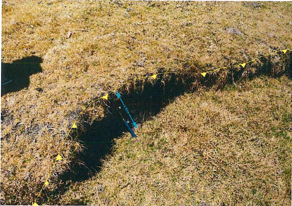
Figura 13. Se observa saltos de 0.52m, estas se encuentran en las siguientes coordenadas UTM 8841147 N, 281931 E con una cota de 3369 m s.n.m, cabe mencionar que estos saltos se encuentran a 20m del deslizamiento anteriormente descrito.
