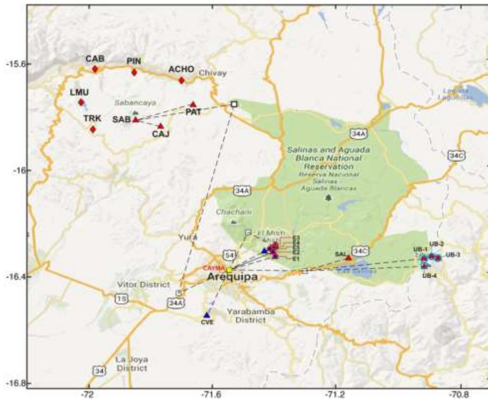
**Figura 12.-** Esquema de las redes de estaciones sísmicas-telemétricas que funcionan en tiempo real para la vigilancia de los volcanes activos del Sur del Perú. El Observatorio OVA-IGP centraliza la información.
