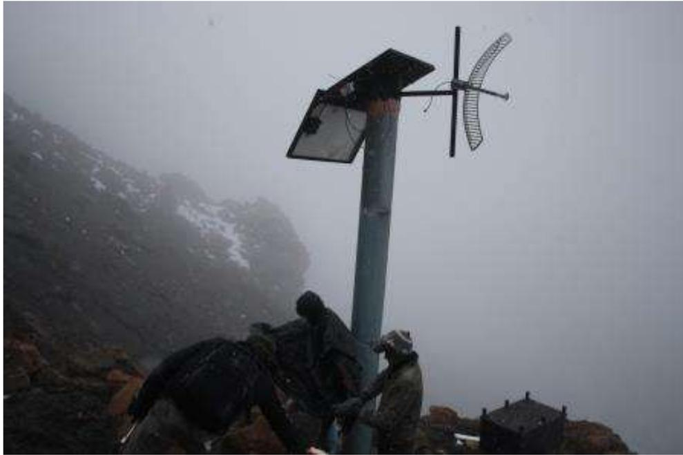
**Figura 11.-** Estación sísmica SAB (5200 msnm), de la red telemétrica del Sabancaya. Esta estación está muy cerca del cráter y está diseñada para el monitoreo en condiciones climáticas extremas. Los datos son enviados en tiempo real hasta el OVA-IGP
