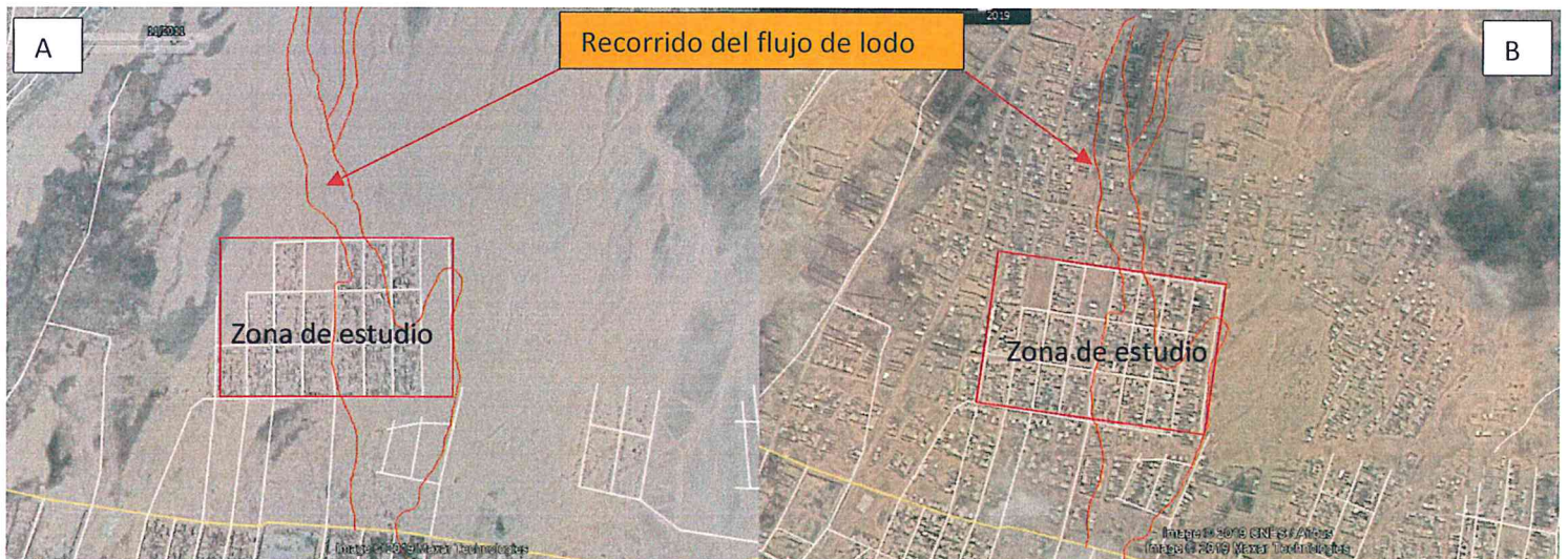
Figura 29. Vista de imágenes satelitales de Google Earth, del año 2011(A) y del año 2019(B) que sirvieron para delimitar y diferenciar el verdadero surco por donde recorre la quebrada estacional, e identificar las zonas afectadas del A.A.H.H. Túpac Amaru II Etapa y alrededores. Fuente: Elaboración propia 2019
