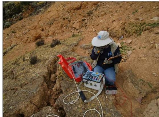
**Figura 5.** Vista de los escarpes del deslizamiento y la disposición de los equipos para la adquisición de datos de resistividad.
