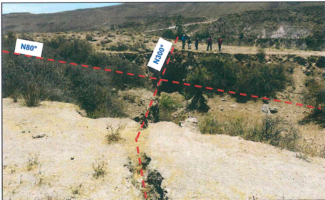
Figura 8. Fallas locales ubicados al extremo suroeste del deslizamiento principal, una de ellas presenta una dirección preferente de N80^\circ , la otra presenta una dirección preferente de N300^\circ .
