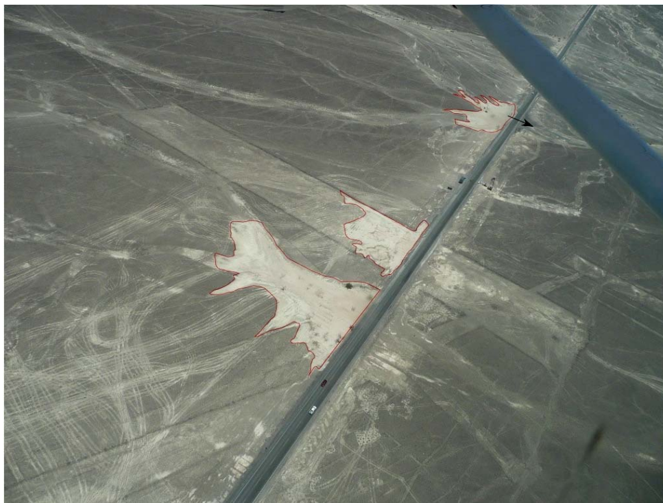
Fig. 14: Vista aérea de la Panamericana Sur, cerca al sector de la Torre de Observación turística. En líneas naranjas se observa las marcas de las lagunas temporales que se formo represarse los flujos en la panamericana sur. La flecha negra indica la ubicación del único sistema de alcantarillado de la zona.
