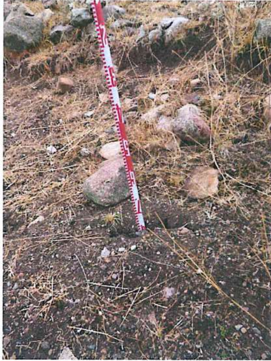
Fotografía 5: Agrietamiento con abertura de 3 cm ubicado por detrás de la corona del deslizamiento D1.
