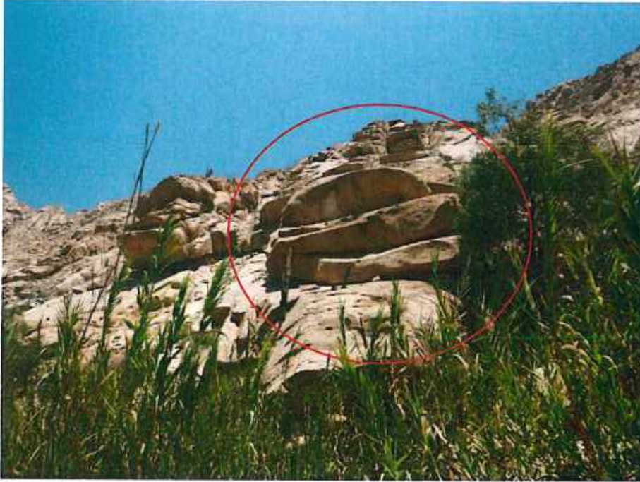
Figura 2. Se observa evidencias del grado de fracturamiento y meteorización en los afloramientos ígneos del Batolito de la Costa, que produce caída de rocas.
