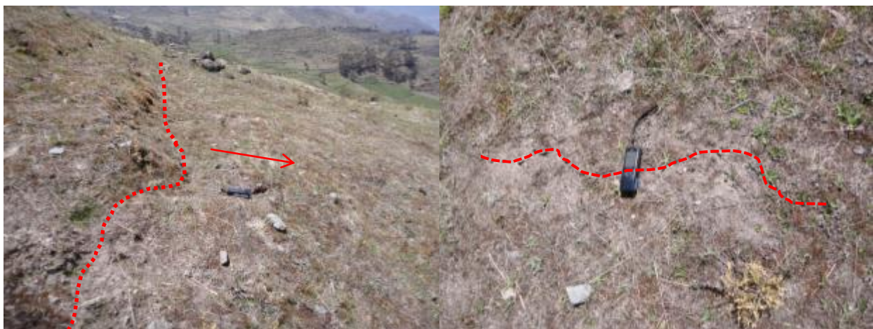
Foto 11: Vista de asentamiento y grietas transversales en la parte alta de la comunidad Astobamba.
