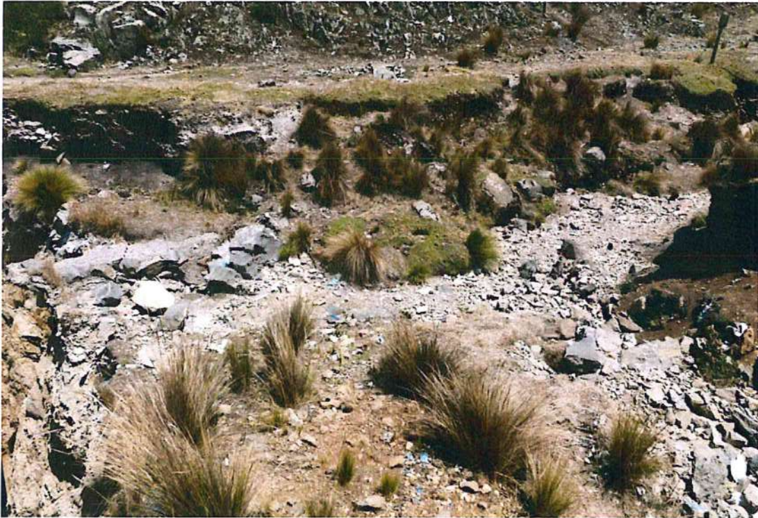
Fotografía 2: Vista de la quebrada Chontacancha aguas debajo, donde se puede observar el material gravo-limoso, con bloques; los fragmentos de roca tienen forma angulosa.
