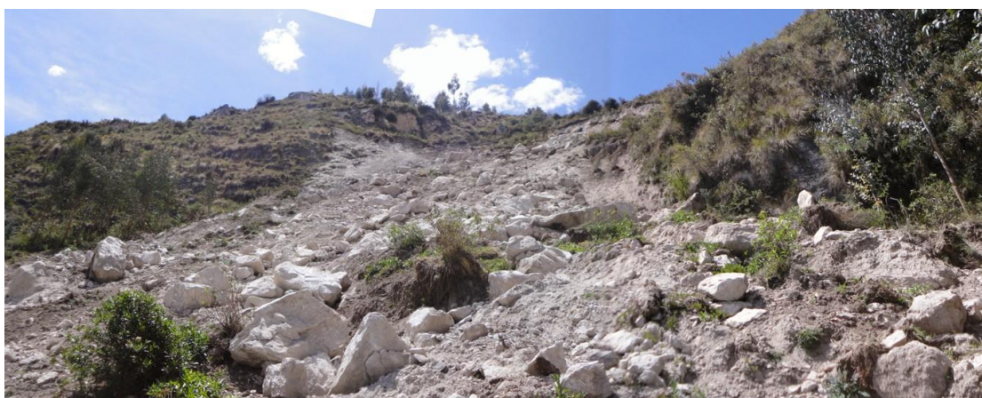
Foto 8: Vista ladera arriba del deslizamiento, se observa los boques y material areno gravoso con limos.
