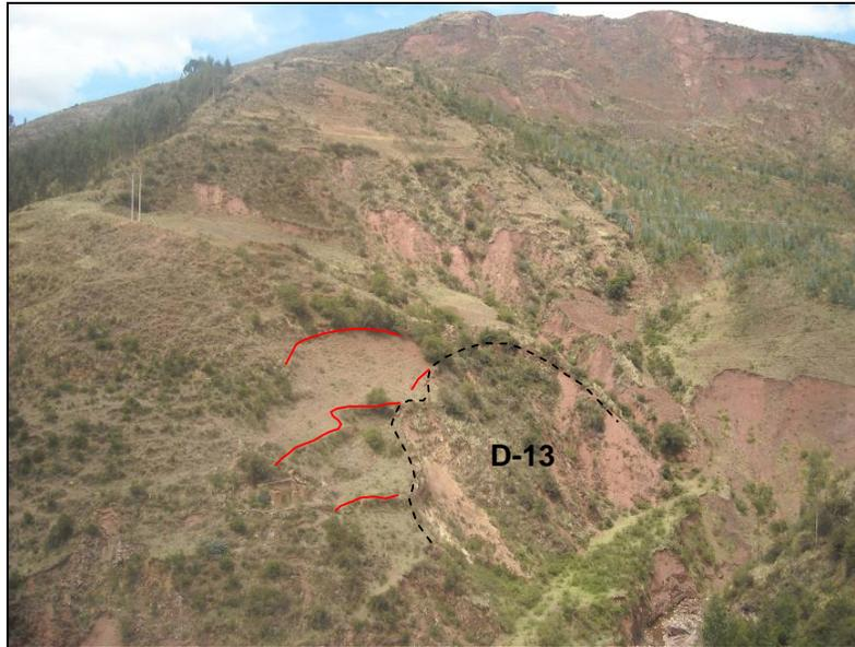
Figura 15: Se observa en línea punteada negra la escarpa del deslizamiento D-13 y en líneas rojas las grietas y desniveles en la cabecera del deslizamiento.
