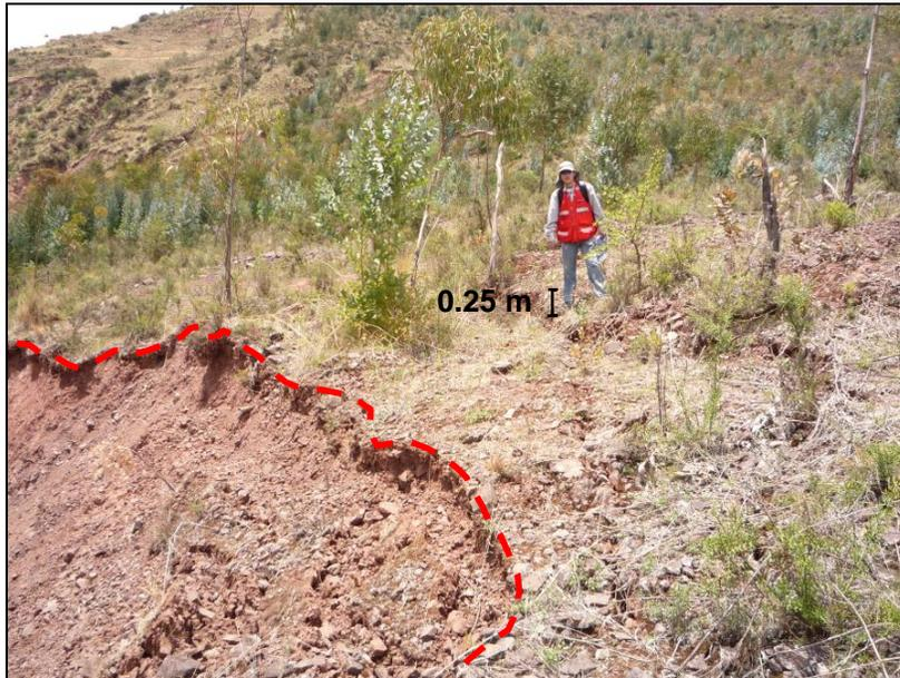
Figura 14: Se observan grietas de hasta 0.25 m de desnivel sobre la escarpa del deslizamiento D-12
