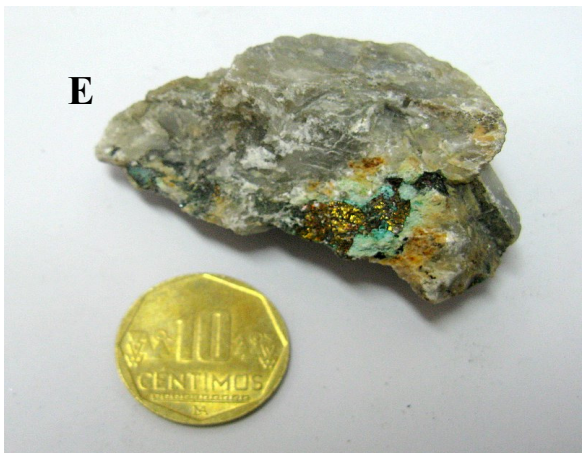
Foto 03.- A) y B) Venillas de calcita con calcopirita. C),D), E) y F) Calcopirita disseminada formando halos de malaquita y azurita. Prospecto Huallpachaca.
