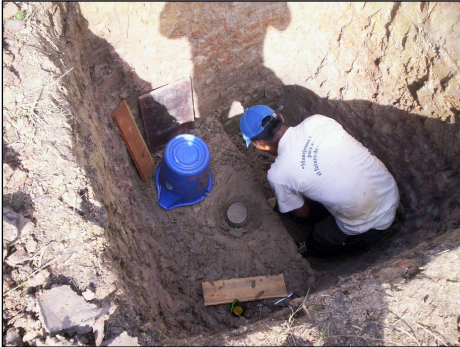
Foto N° 11. Vista general de los trabajos de toma de muestra inalterada de suelos, en la Calicata C3 ubicada en la zona Nor Este de la ciudad de Iñapari.
